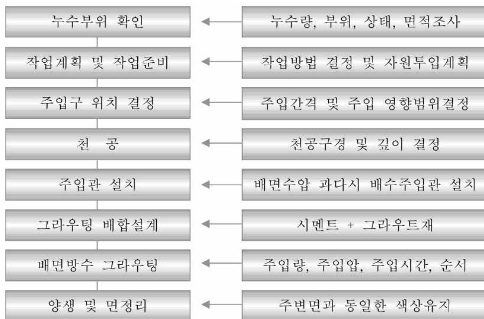
【그림 6.3.12】 배면주입방수 공법의 시공순서도
